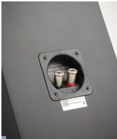
Terminale głośnikowe są lepiej dostosowane do wtyków bananowych niż widełek (mały rozstaw).
