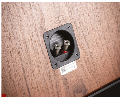
Ciasno rozstawione terminale preferują wtyki o średnicy 4 mm. Obie kolumny są oznakowane jako lewa i prawa.
